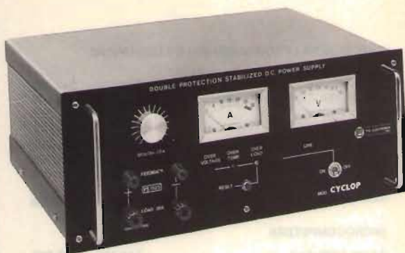
PS 15.25 Alimentatore stabilizzato a tensione variabile
